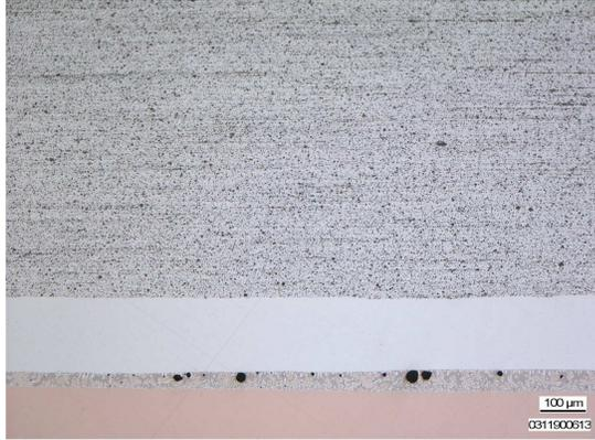
**Bild 11:** Aufgelötete Ag/SnO<sub>2</sub> Kontaktauflage mit Ag-Unterschicht auf Cu-Trägermaterial (Längsschliff)
