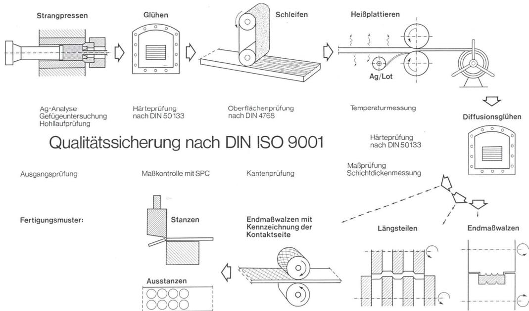
**Bild 12:** Herstellung von Ag/SnO<sub>2</sub>-Profilen und -auflagen
